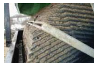
Kolonije bakterija na biološkoj opni biorotora
